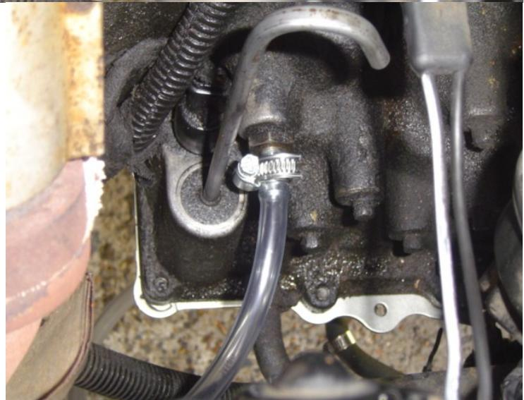
Voici la durite de retour qui pendait pas loin, on lui pose le raccord plastoc blanc qui permet à un tuyau, d'y raccorder un autre tuyau et deux coliers. Au fait, l'ensemble est assez accessible, je n'ai rien eu à démonter de l'avant du véhicule, ici, on est devant, en dessous.
