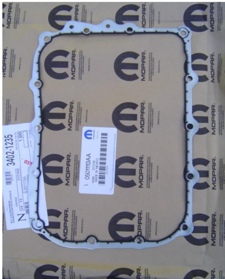
Vérifiez s'il est bien ajusté au carter, dans le cas où il faudrait l'ajuster (mon cas : légèrement décalé vers la gauche) posez le dessus et mettez quelque vis du carter, enfin, ajustez celui-ci en tirant doucement avec les mains.
