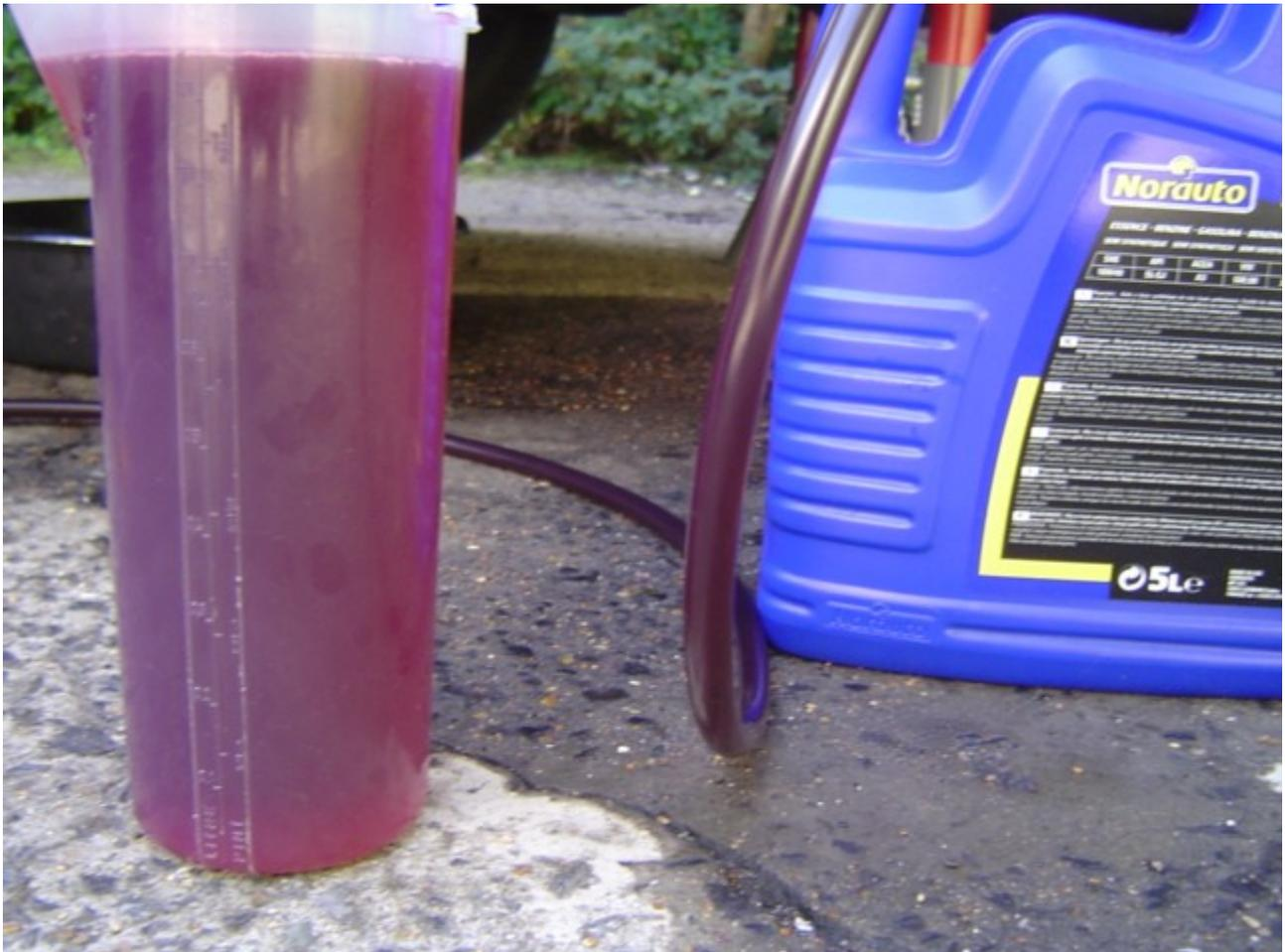
On a du fluide neuf dans le bidon gradué et l'ancien dans le tuyau, ça se voit pas tant que ça, mais celui qui circule dans le tuyau est plutôt marron, signe d'un trop grand échauffement, pas de panique, c'est qu'il est temps de le changer. C'est là du fluide qui serait resté dans la boîte...
