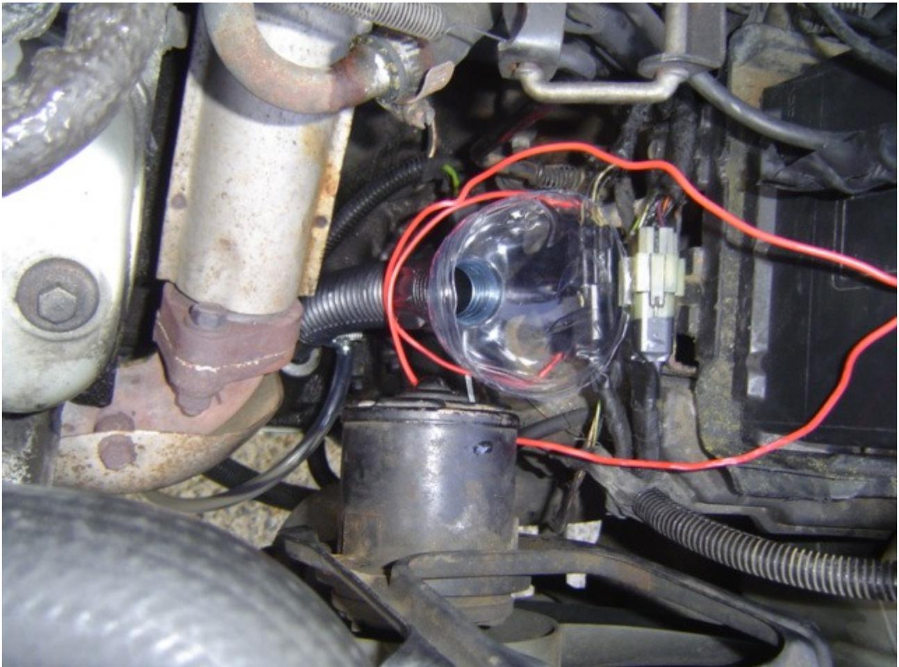
Au dessus, enlevez la jauge, afin de pouvoir effectuer le remplissage, posez un entonnoir (le cône d'une bouteille propre par exemple) et une rallonge flexible (le bazar noir, je l'avais eu avec un kit de vidange, c'est une espèce de rallonge d'entonnoir). Et pour éviter que ça parte se coller à la rampe d'échappement des cylindres avants, attachez l'ensemble à la patte de fixation du servocommande de régulateur de vitesse, qui se trouve à droite, sous la batterie.
