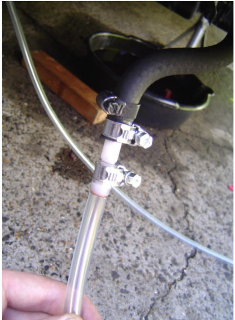
Mais pourquoi j'ai raccordé la pipe et le tuyau?? mais parce que je n'étais pas sûr duquel des deux côté le fluide allait sortir! Mais après expérience, il sortira de la durite. Ce montage permet de clamper le retour sur la boîte, pour qu'aucune cochonnerie y rentre (pliez le tuyau en deux et scotchez le).
