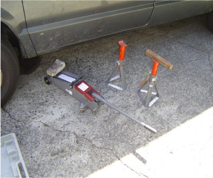
Levez la bête à l'aide du cric et posez le sur des chandelles (je positionne le cric sur le faux chassis avant et les chandelles sur les longerons juste derrières).
